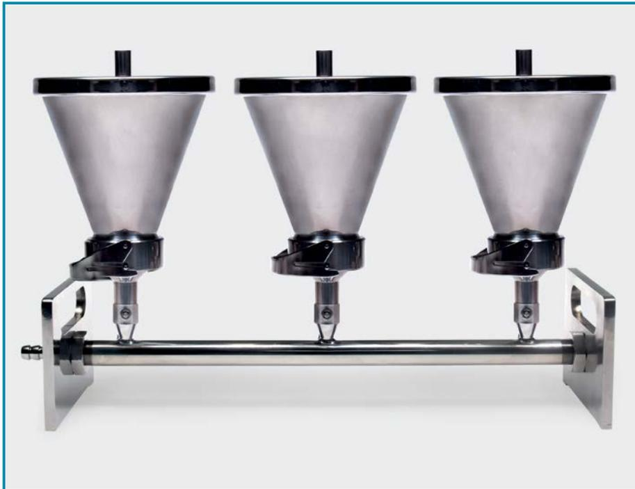
► Los colectores de vacío permiten la filtración de múltiples muestras, ya sea de una vez o independientemente, controlando las válvulas de derivación separadas. Adecuado para ser utilizado con filtros de membrana de 47/50 mm de diámetro.
