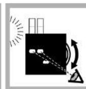
**7.** Sostenga la caja del comparador de colores delante de una fuente de luz. Gire el disco de color hasta que los colores coincidan.
